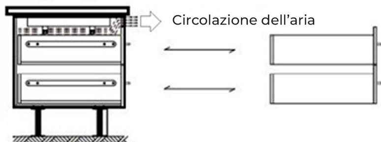
(\*) Ogni volta che sotto il sistema a induzione è presente un forno, è obbligatorio installare una griglia di ventilazione
